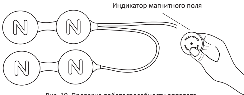
Рис. 10. Проверка работоспособности аппарата с помощью индикатора магнитного поля
